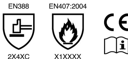
È conforme alle disposizioni del Regolamento 2016/425 e alle norme europee armonizzate EN 420:2003+A1:2009, EN388:2016+A1:2018, UNI EN 407:2004 ed è identico al DPI che è stato soggetto di un'attestazione di conformità UE di tipo rilasciata con validità di 5 anni dall'organismo notificato n°0465 con il numero:
