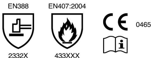
È conforme alle disposizioni del Regolamento 2016/425 e alle norme europee armonizzate EN 420:2003+A1:2009, EN388:2016+A1:2018, UNI EN 407:2004 ed è identico al DPI che è stato soggetto di un'attestazione di conformità UE di tipo rilasciata con validità di 5 anni dall'organismo notificato n°0465 con il numero:
