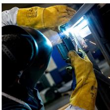
GUANTO DA SALDATURA TAGLIATO E CUCITO 100% CUOIO CROSTA CON PALMO IN TRIPLO STRATO
